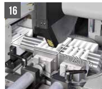
16 TIGER 402 CNC HR 4.0 Serie di ganasce a pettine in nylon max 75x75
