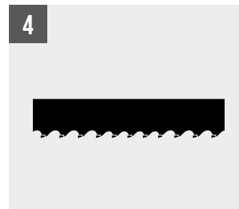
4 Nastro con denti in metallo duro elettrosaldati
