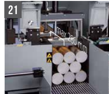
21 SHARK 420 CNC HS 4.0 - Morsa verticali idrauliche per tagli a fasci (420 x 420 mm)
