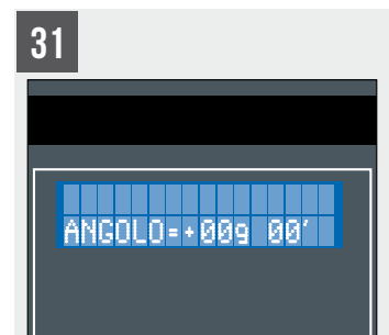
31 SHARK 512 SXI evo Visualizzazione angolo di taglio
