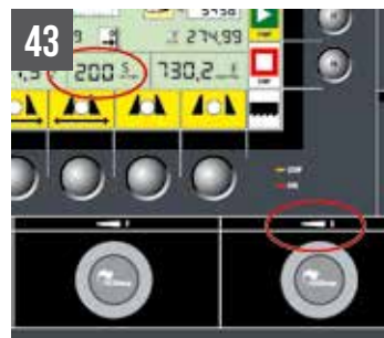
SHARK 420 CNC HS 4.0 SHARK 350 CNC HS 4.0 / 350 NC HS 5.0 KIT velocità lama 15±200 m/min
