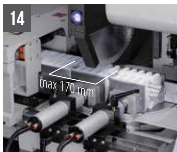
14 TIGER 402 CNC HR 4.0 / RC Serie di ganasce a pettine in nylon max 75x75 mm per riduzione sfrido
