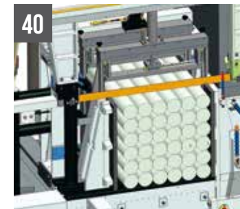
SHARK 660 CNC HS 4.0 - Morse verticali idrauliche per tagli a fasci (660 x 660 mm)
