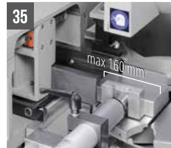
35 TIGER 402 CNC HR 4.0 Morsa speciale riduzione sfrido
