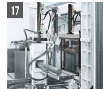
17 SHARK 350 NC HS 5.0 - Morse verticali idrauliche per tagli a fasci 350x350 mm
