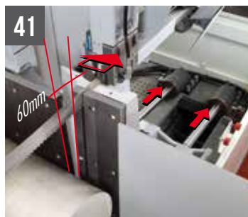
SHARK 660 CNC HS 4.0 - Borsa di taglio con ganascia posteriore retrattile
