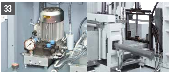
33 SHARK 350 CNC HS 4.0 Morsa verticali idrauliche con centralina idraulica dedicata 350x350 mm
