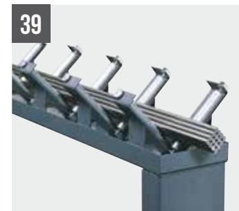
Pianale a rulli lato carico per ganasce a pettine 1500 mm
