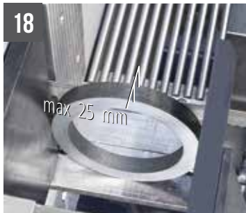
18 SHARK 350 CNC HS 4.0 - 350 NC HS 5.0 Morsa speciale riduzione sfrido max 25 mm
