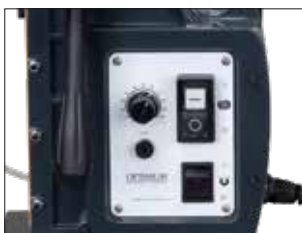
Pannello di controllo Disposizione semplificata degli interruttori per un facile utilizzo
