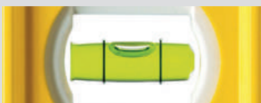
Fiala verticale – per misurazioni verticali.
