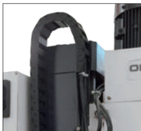
· Disposizione dei collegamenti tramite catena
