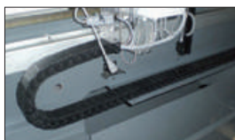
· Disposizione dei collegamenti tramite catena
