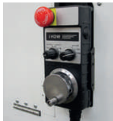
Volantino elettronico . Riduce il tempo di configurazione . Interruttore di emergenza . Pulsante di abilitazione
