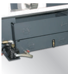
Serbatoio del refrigerante · Vaschetta portatrucoli estraibile · Serbatoio del liquido lubrorefrigerante estraibile · Spia indicatrice di livello · Portata serbatoio 50 litri
