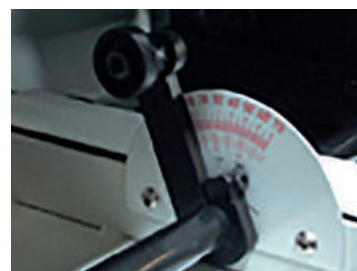
Impostazione rapida e precisa dell'altezza tramite leva regolabile con scala
