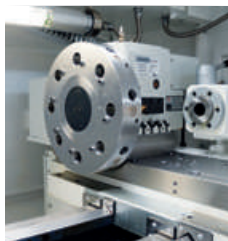
Sistema di cambio utensile · Otto posti utensili · Torretta utensili idraulica VDI30 · Altezza max attacco 20 mm
