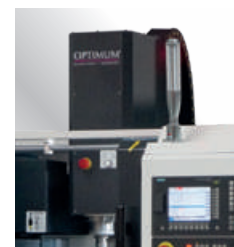
Spia luminosa di segnalazione . Mostra in modo ottico lo stato della macchina
