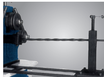
Su richiesta: utensile curvatura per pezzi speciali come ad es. ferro battuto
