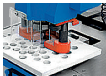
Stazione di punzonatura
